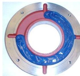
Figura 7.2: Anel de fixação externo do mancal
