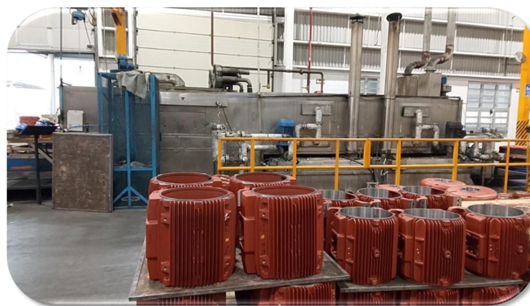
Visão de perfil da lavadora de componentes, com carcaças de motor à frente
