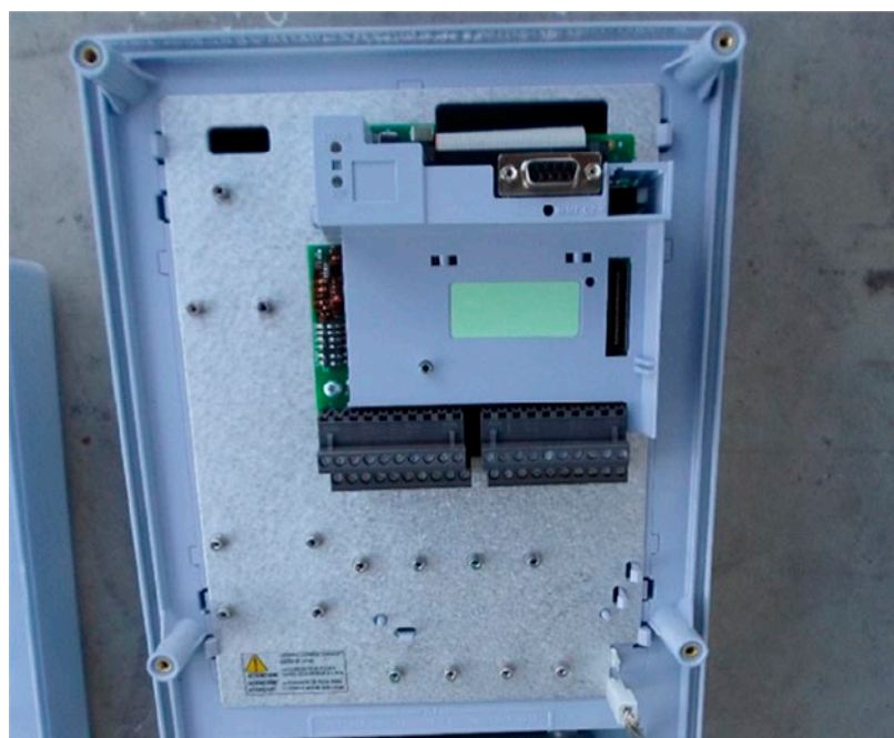
Lado interno de la muestra 01 tras 8 horas de la prueba de polvo; placas de control
