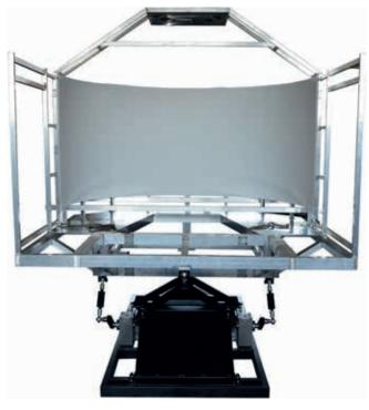
ein neues Antriebskonzept. Neu implementiert wurden sowohl die Servo-Steuerung, die alle Berechnungen für die Bewegungen ausführt, als auch die Servo-Antriebe und die Getriebemotoren.
