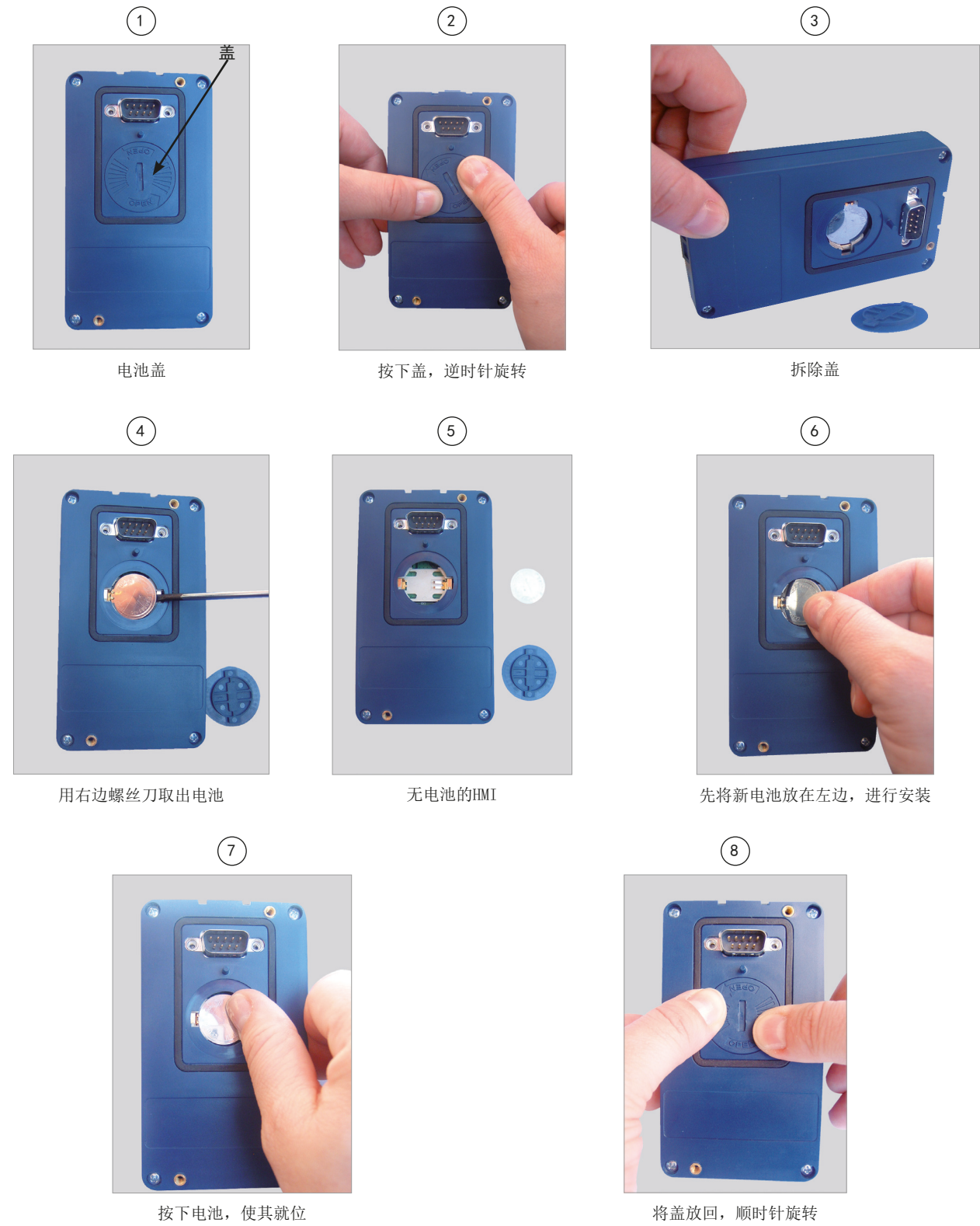
图4. 2: 更换HMI电池
