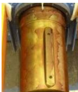
Figura 2: Anti-corrosivo nas partes usinadas
