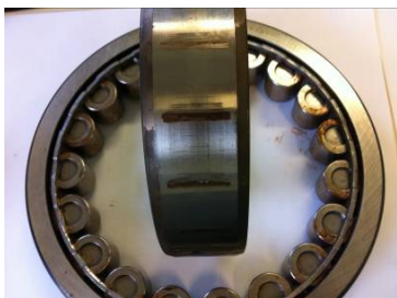
Figura 24: Impressões superficiais (false brinelling)
