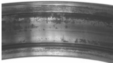
Figura 23: Corrosão estática na pista externa do rolamento
