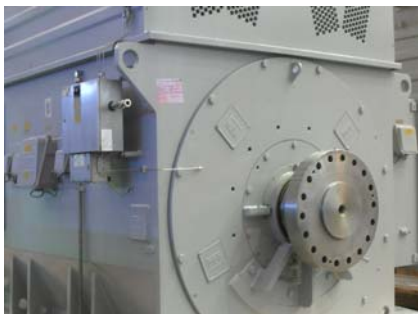
Figura 9: Máquina com mancal único
