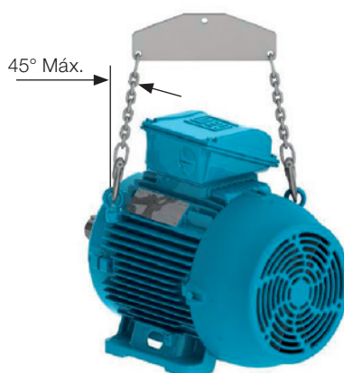
Figura 7 - Ângulo máximo resultante para motores com dois ou mais olhais de içamento
