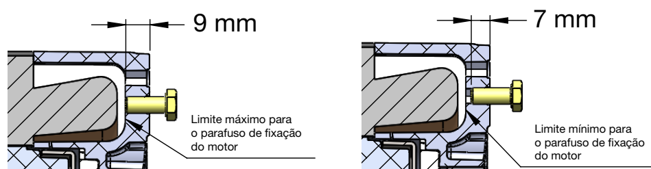
Figura 38 - Límite de profundidad del engaste
