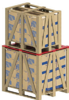
Figura 30 - Utilização de sarrafos adicionais para empilhamento
