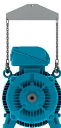
Figura 10 - Uso de barra separadora no içamento
