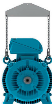
Figura 10 - Uso de barra separadora en la elevación
