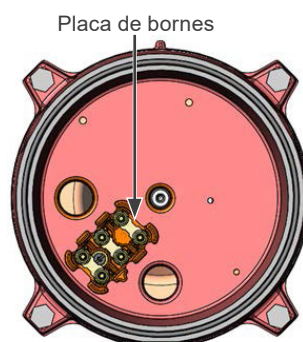
Figura 6.5: Detalhe da placa de bornes
