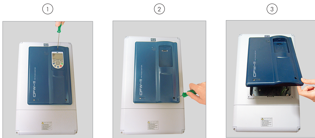
Figura 3.6 - Remoção da HMI e da tampa do rack de controle
