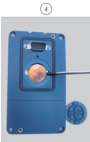
Remover a bateria com o auxílio de uma chave de fenda posicionada no canto direito
