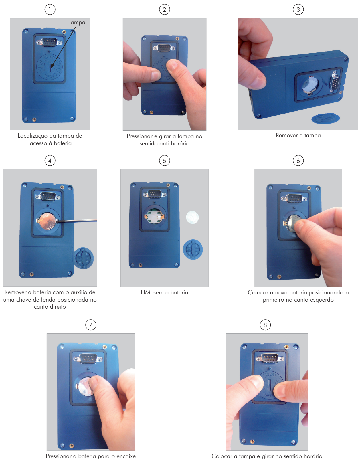
Figura 4.2 - Substituição da bateria da HMI
