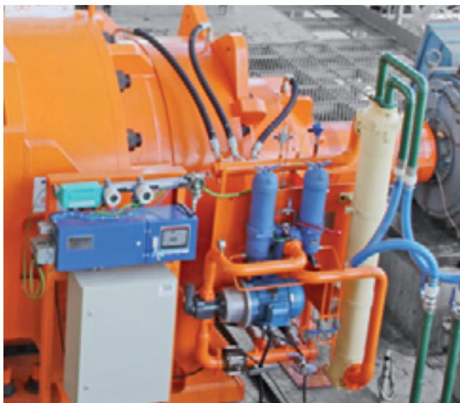
La perfecta lubricación es uno de los destaques del G3 Full. Construidas para permitir la mejor condición de filtrado y refrigeración del aceite lubricante, las unidades hidráulicas son constituidas con elementos para filtrado absoluto, 10 micras (β 200) y con intercambiador de calor de alta performance, todo eso integrado al sistema de monitoreo electrónico.
