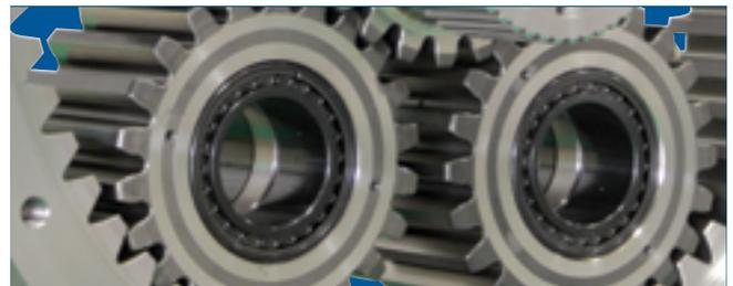
Los cojinetes tienen un tratamiento superficial de Óxido Negro y están dimensionados para una vida útil  $L_{10h} \geq 100,000$  horas según ISO 281 y el factor de servicio  $\geq 2$ , lo que contribuye a la eficiencia y seguridad de los mismos.
