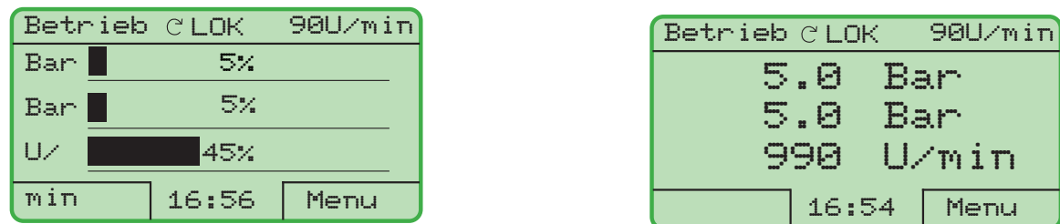
Abbildung 22.4: Beispiel für das Tastenfeld (MMS) im Überwachungsmodus für die Funktion PID-Regler
