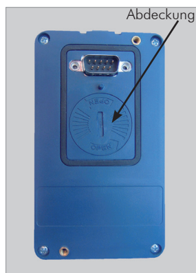
Deckel für Batterie-Zugang
