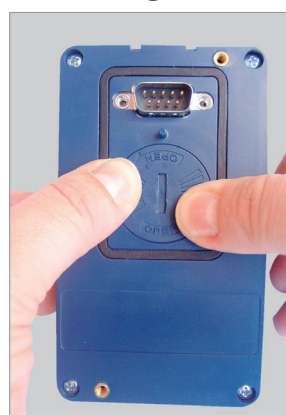
Die Abdeckung wieder aufsetzen und im Uhrzeigersinn drehen
