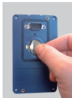
Zum Einbau der Batterie diese zunächst auf der linken Seite einlegen
