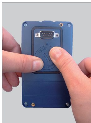
Die Abdeckung mit dem Finger eindrücken und gegen den Uhrzeigersinn drehen
