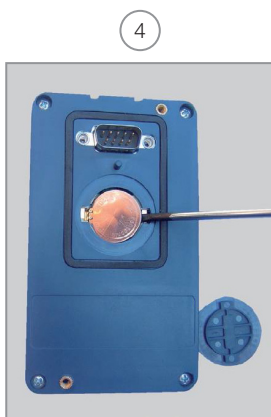
Извлеките батарею с помощью отвертки, расположенной справа
