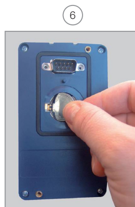
Установите новую батарею, вставив ее сначала с левой стороны
