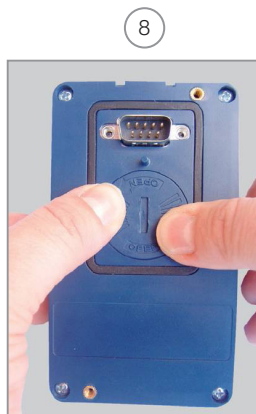
Вставьте крышку обратно и поверните ее по часовой стрелке
