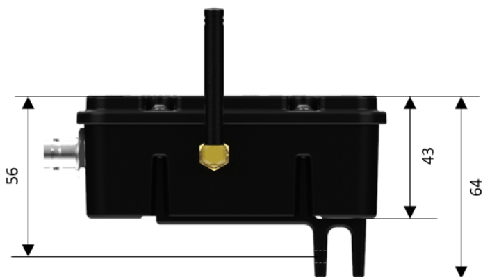
Figura 3.6: Dimensões [mm] externas do WEGscan400 com presilha para aletas - Vista lateral
