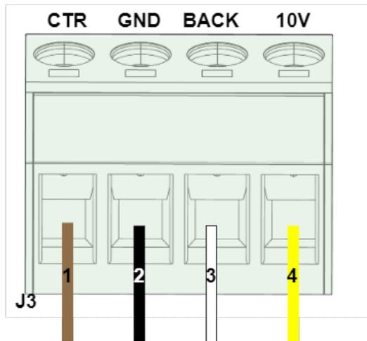
Abbildung 12 - Anschlusssequenz des Controllers.
