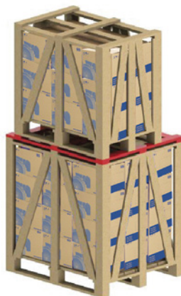
Рисунок 5.5 – Использование дополнительных реек для штабелирования
