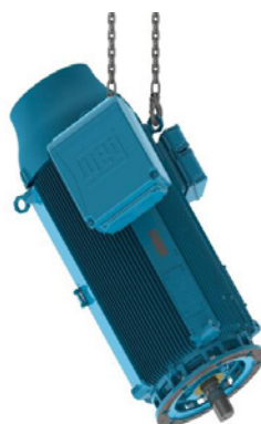
Рисунок 4.8. - Подъем двигателей W51HDХес, W50Хес и HGF Ех ес. за болты с проушиной на неприводной стороне
