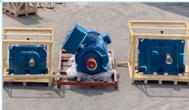
具有“慢速驱动”系统的特殊项目: 该系统旨在客户慢速运行磨矿机以进行清洁和维护的需求, 电机设计为双轴端, 并且在电机背面安装了低速减速度器。电机采用特殊电气设计, 满足扭矩、电流和其他规格标准。该制造商是该国和邻近国家诸多矿业公司中忠诚度较高的一家客户, 有望创造增加安装基数额商机。该制造商不仅生产磨矿机, 还生产破碎机、输送机等设备。
