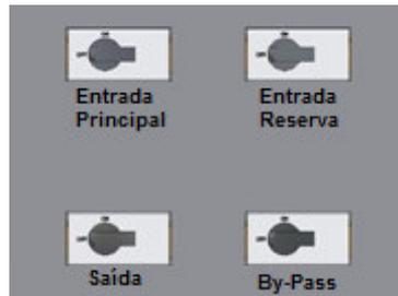
A partir deste momento o sistema está completamente isolado e a carga conectada diretamente a entrada principal.
