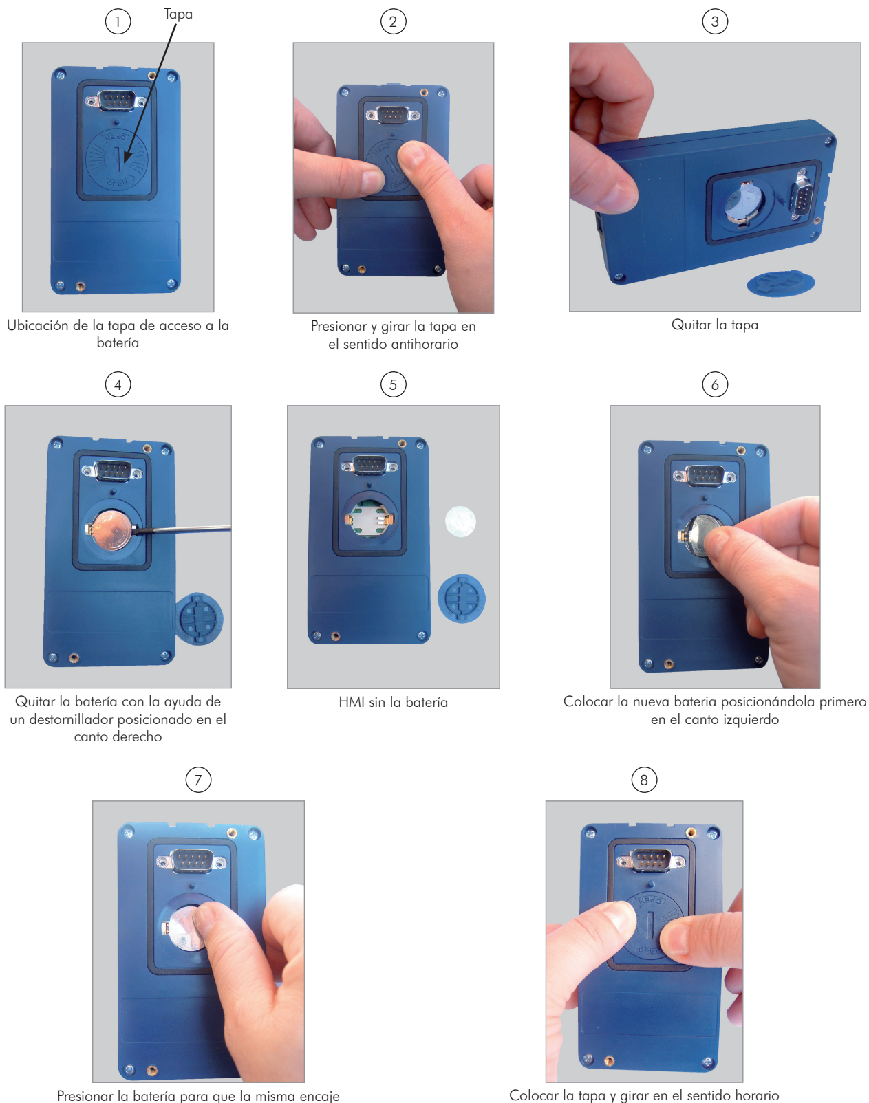
Figura 4.2 - Sustitución de la batería de la HMI
