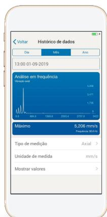
Figura 9.15 - Análisis en frecuencia de la vibración - visualización en la aplicación
