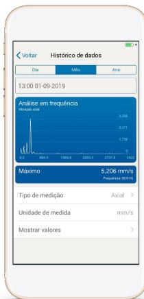
Figura 9.15 - Análise em frequência da vibração - visualização no aplicativo
