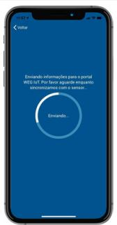
Acesse a WEG IoT Platform para verificar se o sensor aparece na planta do ativo motor elétrico. A partir de agora, o sensor está corretamente configurado e aparecerá na tela Home do aplicativo. Execute o processo de sincronização periodicamente para baixar as medições agendadas.
