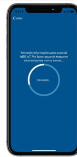
Entre en la WEG IoT Platform para verificar si el sensor aparece en la planta del activo motor eléctrico. A partir de ahora, el sensor estará correctamente configurado y aparecerá en la pantalla home de la APP. Ejecute la sincronización periódicamente para bajar las mediciones programadas.
