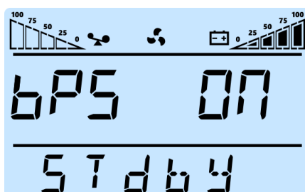
Figura 5.16: Configuração da operação do modo bypass
