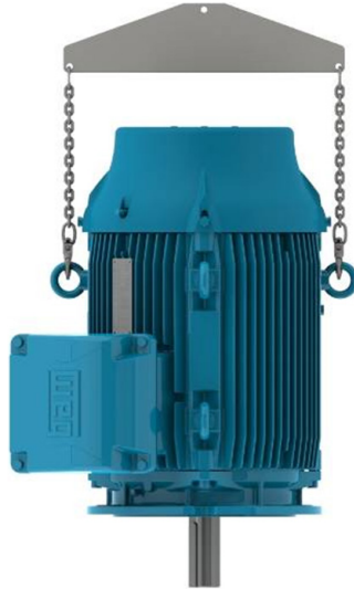
4.8 Ábra: Függőlegesen felszerelt motorok emelése
