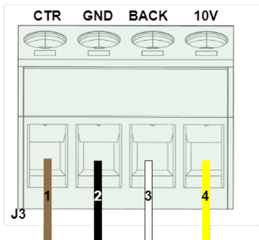
Figur 12 - Anschlusssequenz des Controllers.
