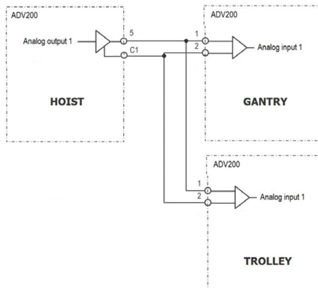
I parametri "ANTISWAY \ Rope length src" e "ANTISWAY \ Rope length dest" permettono di configurare l'uscita e l'ingresso da utilizzare.
