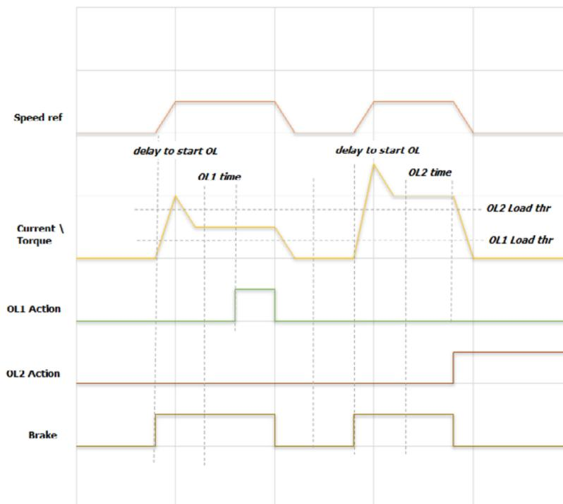
Per determinare se un carico è eccessivo viene misurata la corrente di coppia (drive configurato in modalità V/F) oppure la coppia erogata dal motore (drive configurato in modalità Flux Vector Close Loop o Flux Vector Open Loop). La misura del carico viene effettuata dopo che il drive ha ricevuto il comando di Start (FWD o REV) ed è trascorso il ritardo "delay to start OL".
