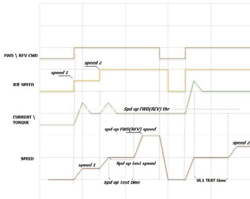
Se è stata selezionata la modalità Hoist Speed Up, al raggiungimento della velocità "Spd up test speed", viene transitoriamente mantenuta la velocità costante ed avviato un test per verificare se la corrente assorbita dal motore (drive configurato in modalità V/F) oppure la coppia erogata dal motore (drive configurato in modalità Flux Vector Close Loop o Flux Vector Open Loop) è inferiore alla soglia "Spd up FWD (REV) thr".
