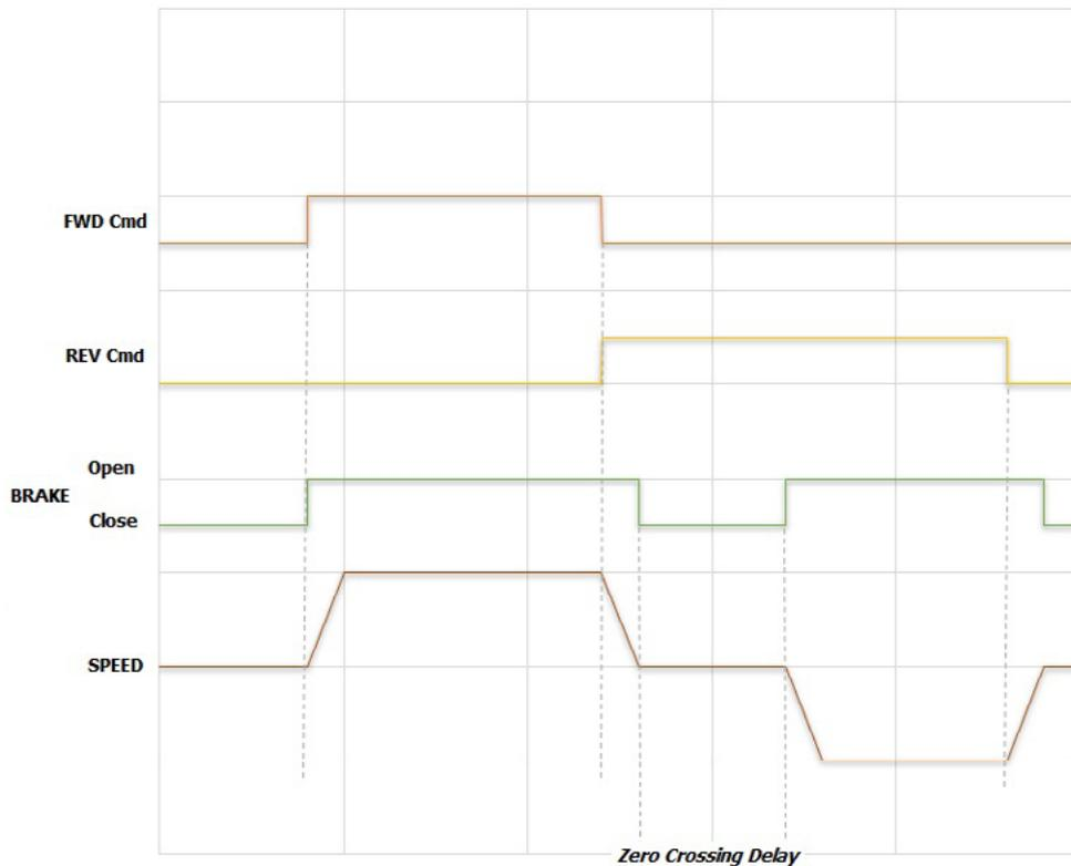
Se si abilita la funzione “ZERO CROSSING” viene impedita l’inversione di marcia senza la chiusura del freno; quando, durante la marcia, viene ricevuto un comando in direzione opposta, se la funzione “ZERO CROSSING” è abilitata, si attiva la sequenza di chiusura del freno, si mantiene chiuso il freno per un tempo pari a “Zero Crossing delay”, successivamente viene riaperto il freno ed eseguito il nuovo comando.
