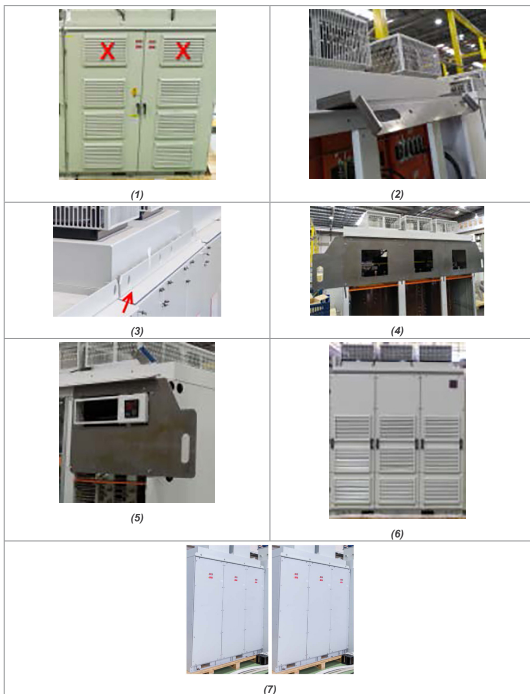
Figura 6.4: Procedimiento de remoción de los refuerzos de transporte aéreo del MVW3000
