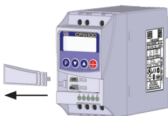
(a) Removal of front cover and accessory (a) Remoción de la tapa frontal y del accesorio (a) Remoção da tampa frontal e de acessório
