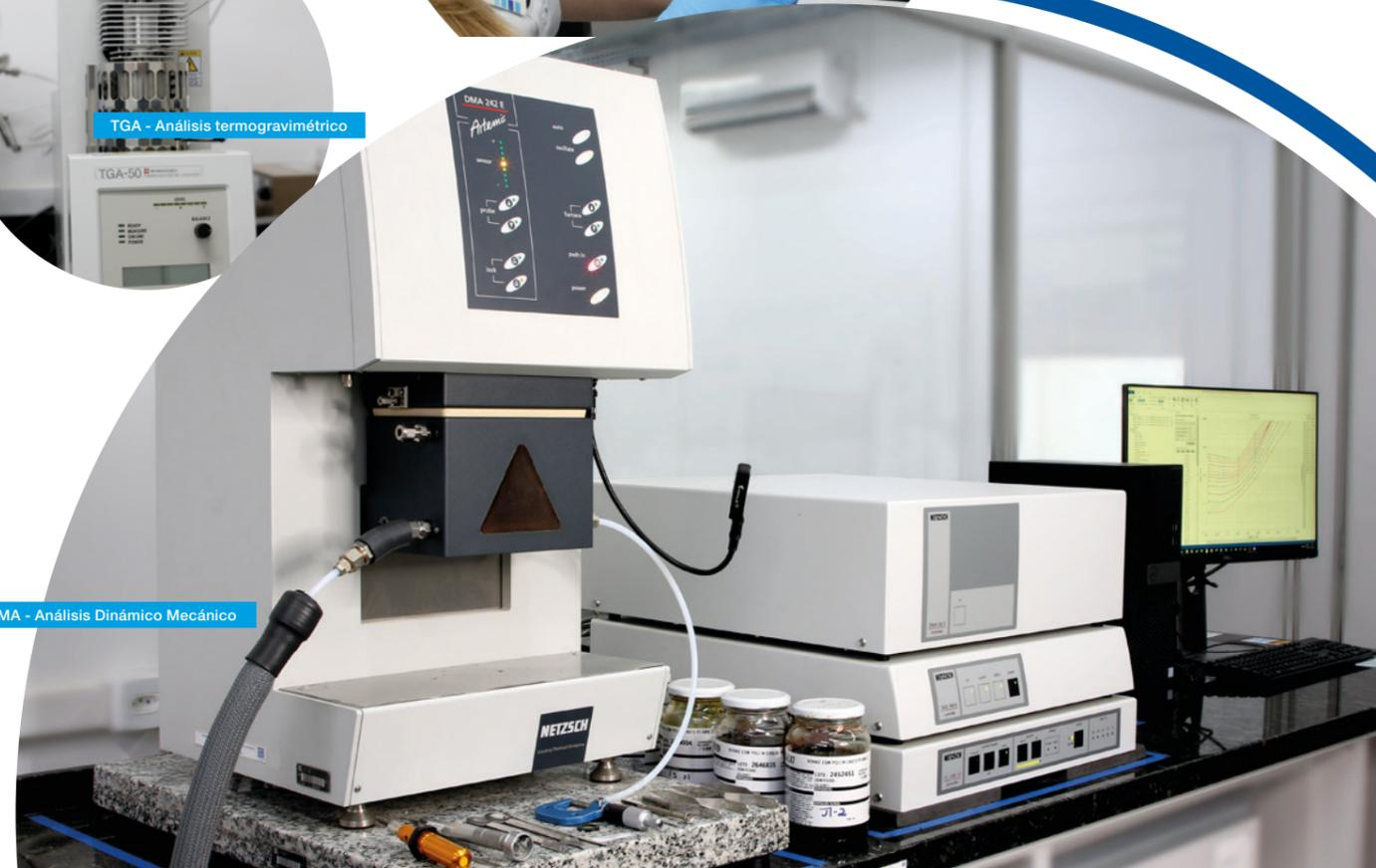
DMA - Análisis Dinámico Mecánico
