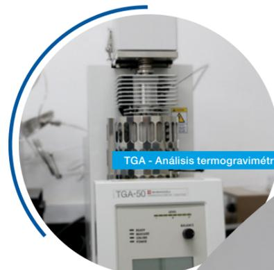
TGA - Análisis termogravimétrico
