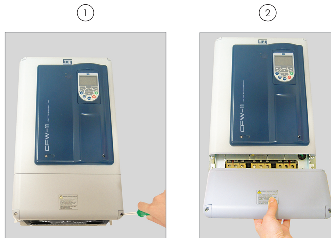
Figura 3.7 - Remoção da tampa frontal inferior
