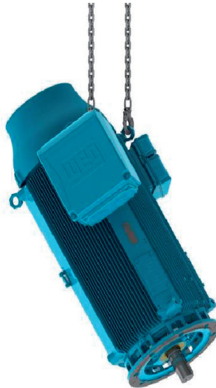
Figura 4.17: Ridicarea motoarelor HGF, W50 și W51 HD cu ajutorul șuruburilor cu ochi de la capătul fără transmisie
