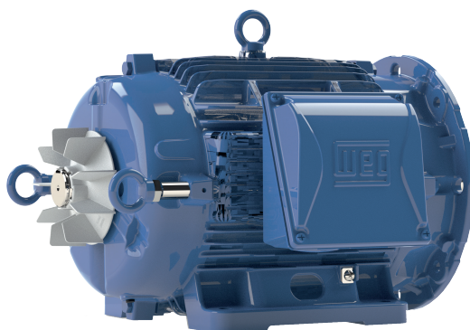
Figura 4.14: Șuruburi cu ochi cu extensie fixate pe partea NDE pentru a poziționa motorul în poziție verticală, cu capătul arborei în jos (V5/V35)
