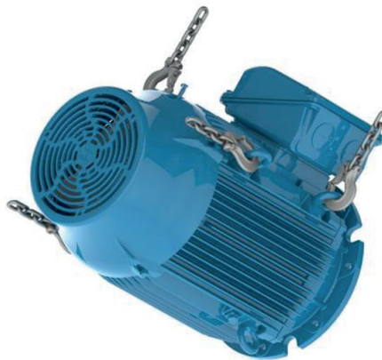
Figura 4.21: Motorul este rotit în poziție orizontală
