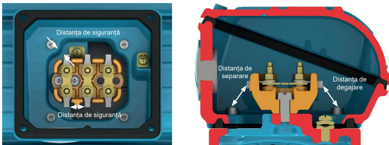
Figura 6.16: Distanța minimă de siguranță (mm) x tensiunea de alimentare
