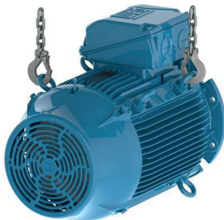
Figura 4.10: Scoaterea motorului din ambalaj
