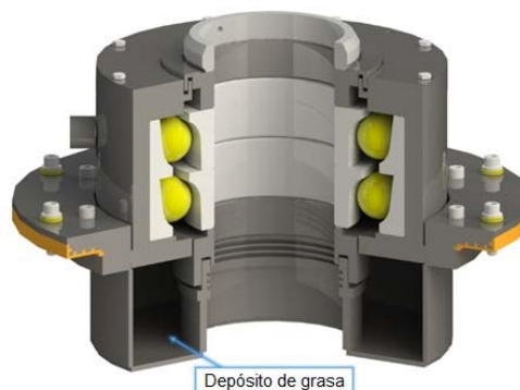
Figura 7.1: Depósito de grasa
