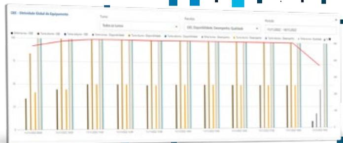
Imagem ilustrativa do OEE da máquina monitorada. É possível utilizar outros tipos de gráficos na exibição do OEE como, por exemplo, o gráfico de barras. Além disso, é possível acompanhar a variação do OEE por dia, semana, mês e ano, gerando relatórios personalizados de acordo com sua necessidade.
