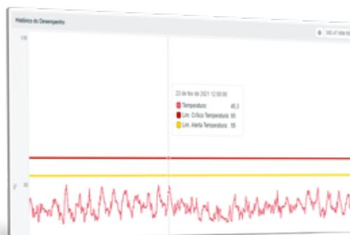
Imagem ilustrativa da possibilidade de configurar níveis de alarmes para cada variável que necessita ser monitorada. Quando a variável monitorada atingir o Limite de Alerta e/ou Limite Crítico, o sistema enviará alertas ao usuário final.
