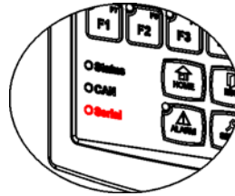
Figura 2.1: LED de indicação da interface Serial
