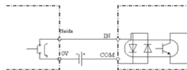
Exemplo 4. PNP tipo coletor aberto
