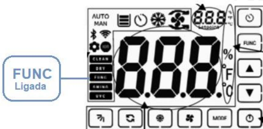
Figura 22 – IHM com indicação da função FUNC
