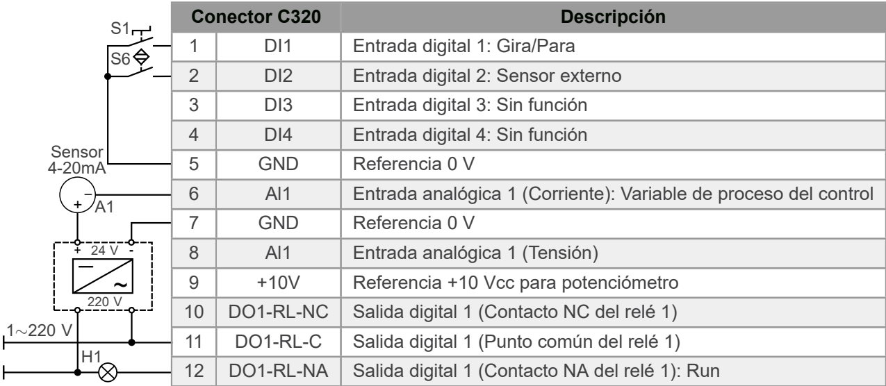
Figura 4.31: Señales en el conector de la tarjeta de control C320 para protección de la bomba vía sensor externo en una entrada digital
