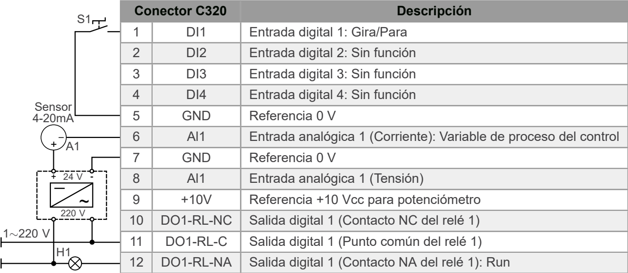
Figura 4.2: Señales en el conector de la tarjeta de control C320 para setpoint (consigna) del control vía HMI o redes de comunicación
