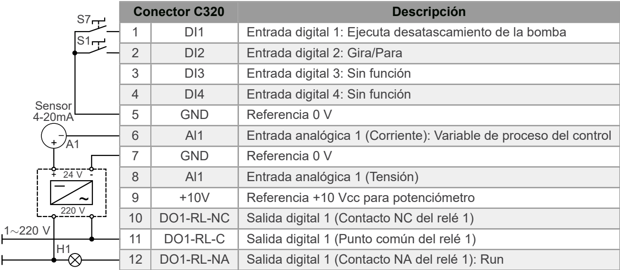
Figura 4.35: Señales en el conector de la tarjeta de control C320 con mando externo en una entrada digital para ejecutar el desatascamiento de la bomba
