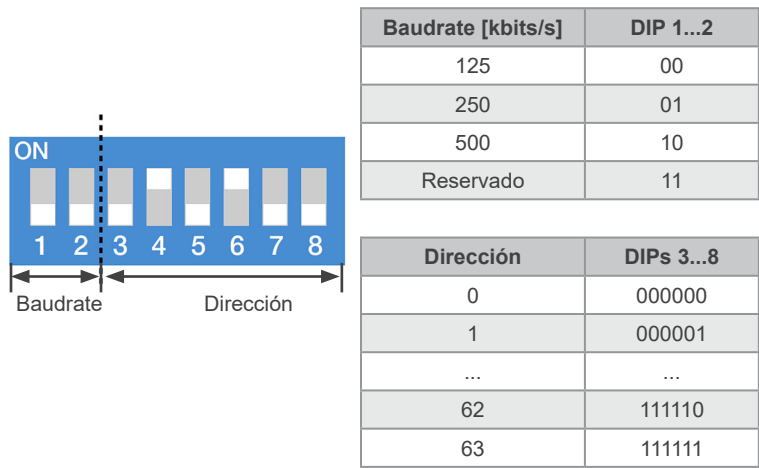
Figura 9.5: Configuración del baudrate y dirección para DeviceNet
