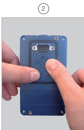
Naciśnij pokrywę i obróć ją przeciwnie do ruchu wskazówek zegara
