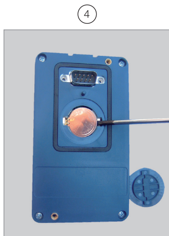
Wymij baterię za pomocą śrubokręta umieszczonego po prawej stronie.
