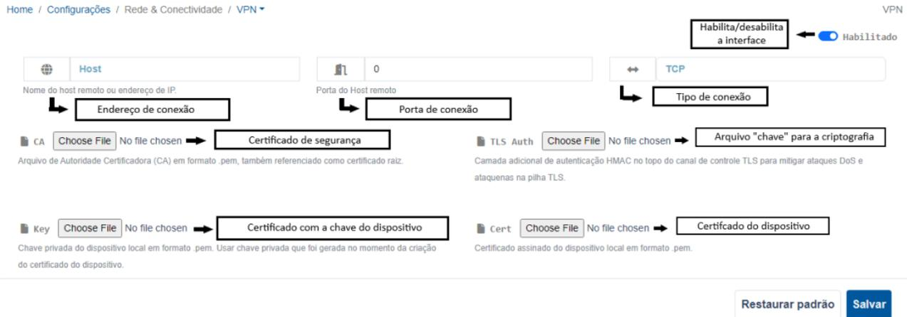
Figura 4.16: Tela de configuração da interface VPN
