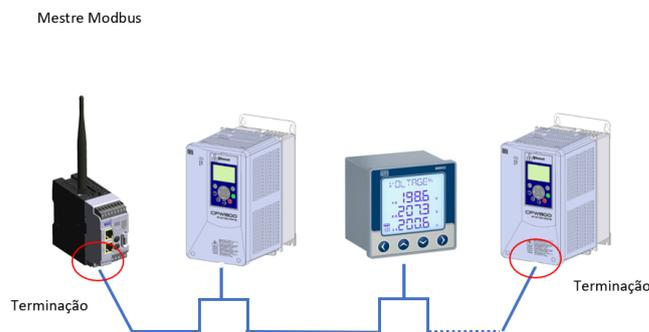
Figura 3.2: Instalação física do ED210 na rede modbus.
