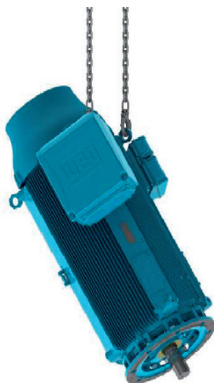
איור 4.17: הרמת מנועי HGF, W50 ו-W51 HD באמצעות הברגים עם העין בקצה שאינו צד ההנעה
