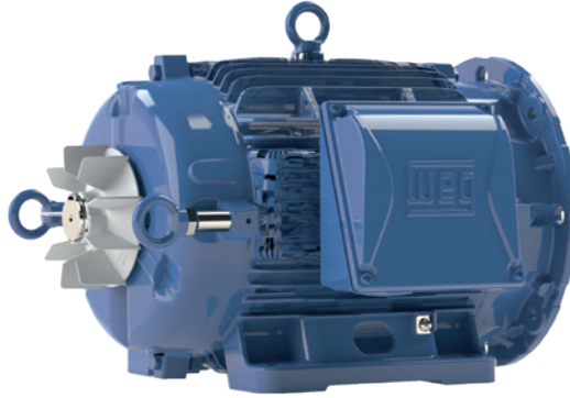
איור 4.14: ברגים עם עין והארכה המותקנים בצד NDE להצבת המנוע במצב אנכי, כאשר קצה הפיר כלפי מטה
