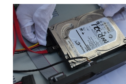
Figura 5-3 Fixação dos cabos
