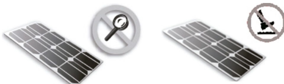
Figura 1.1: Não utilizar vidros amplificadores sobre o módulo e não pisar sobre o módulo.
