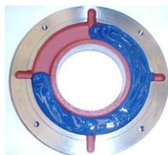
Figura 7.2: Anillo de fijación externo del cojinete
