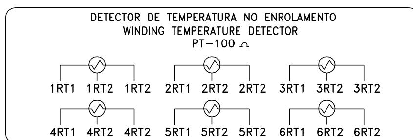
Figura 46 - Esquema de ligação do Pt-100 para enrolamento.
