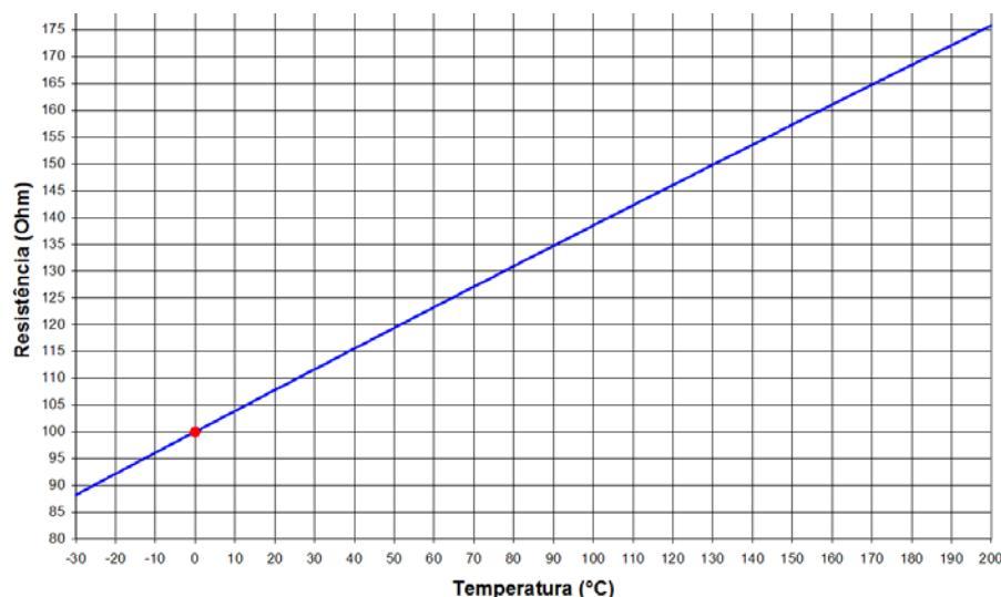
Figura 47 - Resistencia óhmica del Pt-100 x temperatura.
