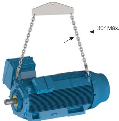
Figura 9 - Ángulo máximo resultante para motores HGF horizontales.
