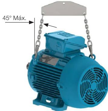
Figura 8 - Ângulo máximo resultante para motores com dois ou mais olhais de içamento.
