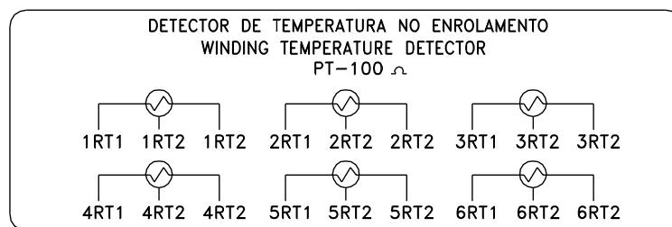
Figura 46 - Conexión de Pt-100 de los bobinados
