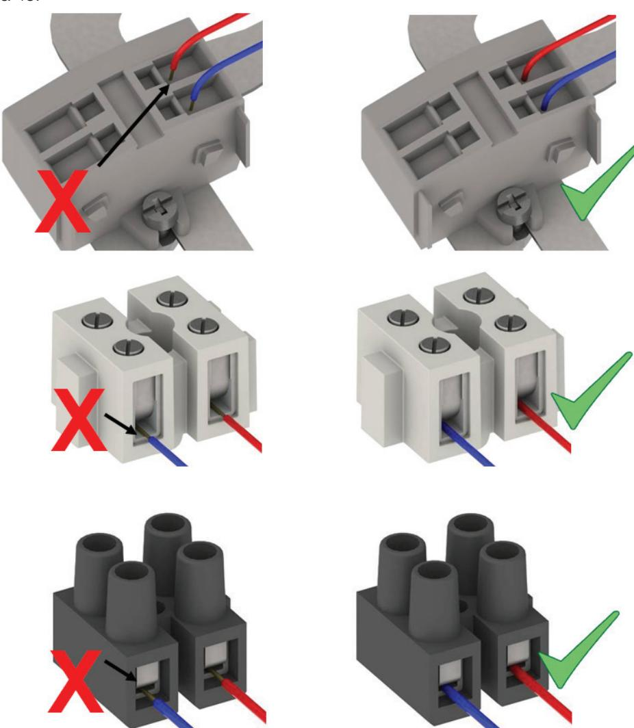
Figura 45 - Conexión de los terminales de las protecciones térmicas
