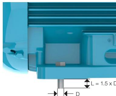
Figura 35 - Representação da fixação do motor por pés
