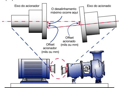
*Figura 39 - Condicão típica de desalinhamento.*
