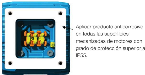
Figura 51 - Superficie mecanizada de la caja de conexión del motor a prueba de explosión.
