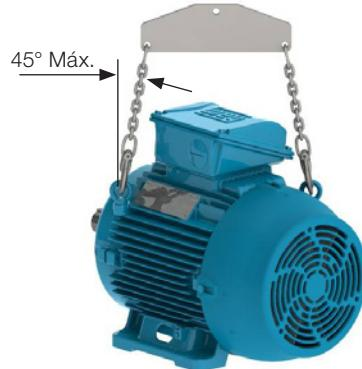
Figura 8 - Ángulo máximo resultante para motores con dos o más ojales de izamiento.
