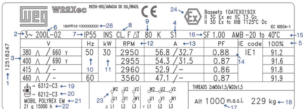
Figura 2 - Placa de identificação de motores IEC.
