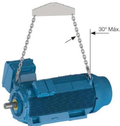
Figura 9 - Ângulo máximo resultante para motores HGF horizontais.
