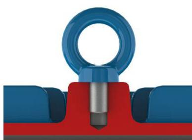
Figura 5 - Maneira correta de fixação do olhal de içamento.
