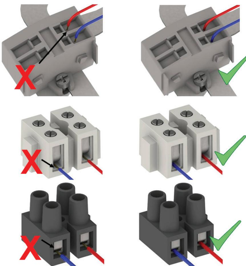
Figura 45 - Conexão dos terminais das proteções térmicas.
