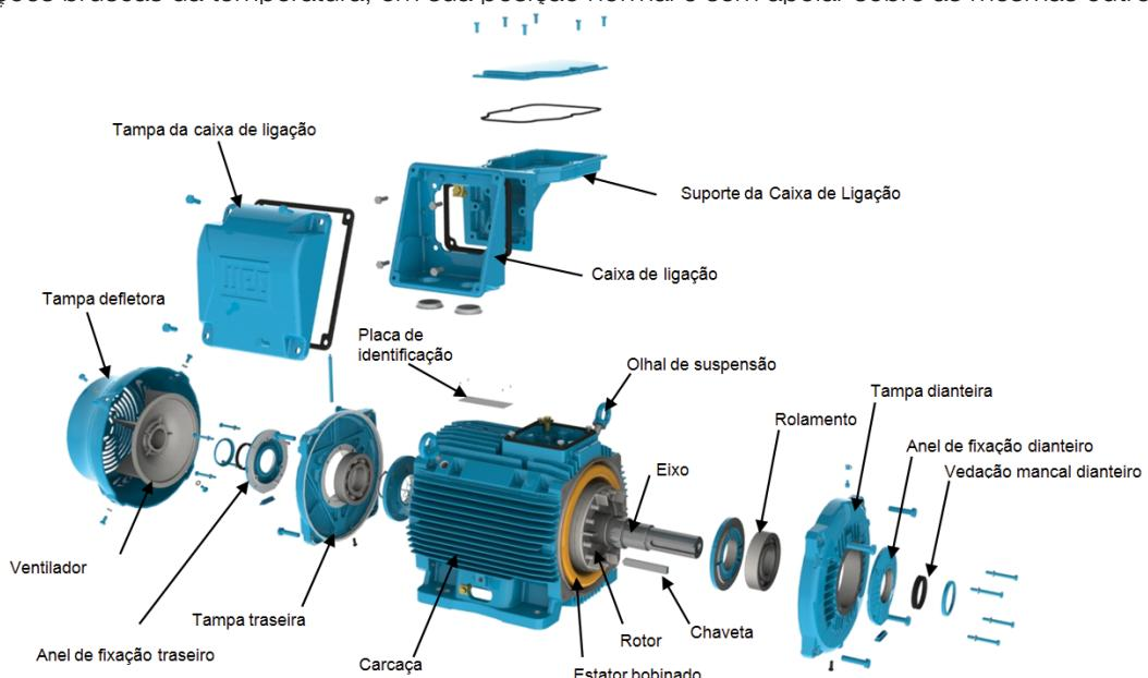
Figura 52 - Vista explodida dos componentes de um motor com tipo de proteção "ec".
