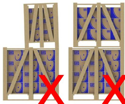
Figura 28 - Apilamiento inadecuado.
