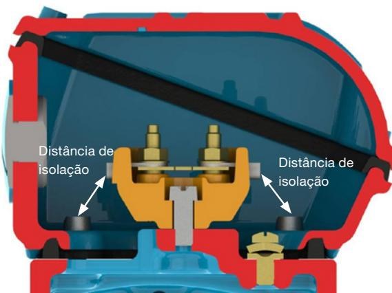
Figura 42 - Representação da distância de isolamento.
