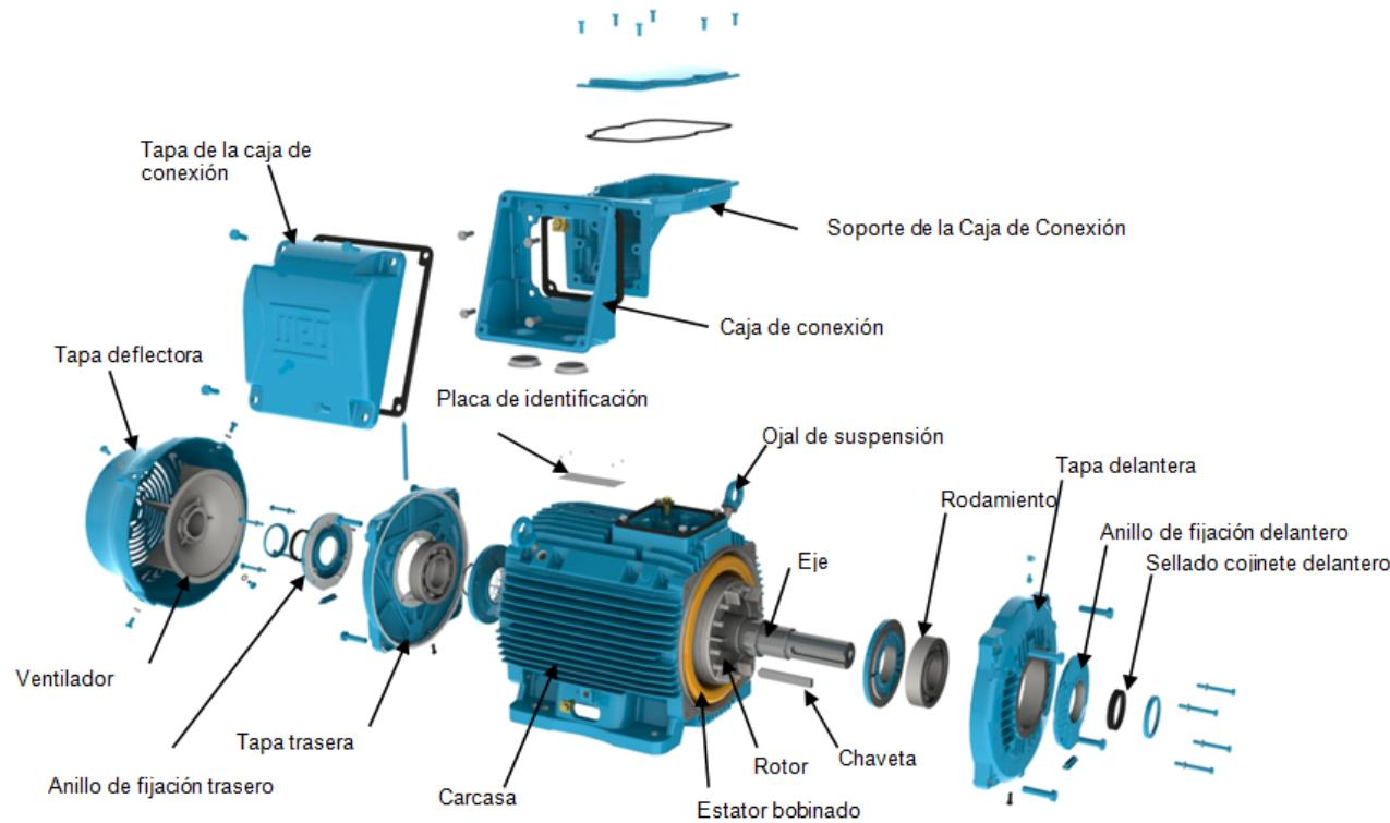
Figura 52 - Vista explotada de los componentes de un motor con tipo de protección "ec"
