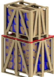
Figura 29 - Utilización de varas adicionales para apilamiento.
