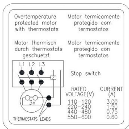
Figura 43 - Conexión de los protectores térmicos bimetálicos (termostatos).
