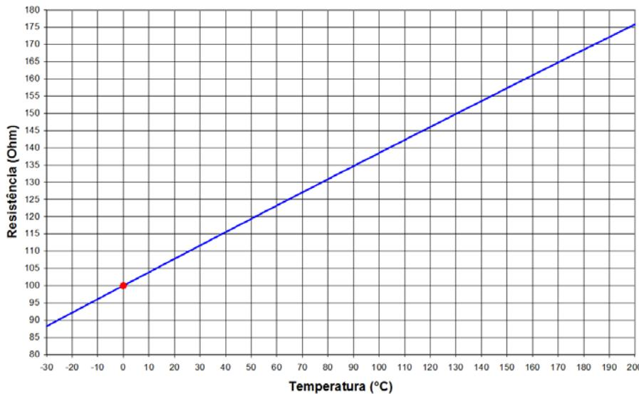
Figura 47 - Resistência ôhmica do Pt-100 x temperatura.
