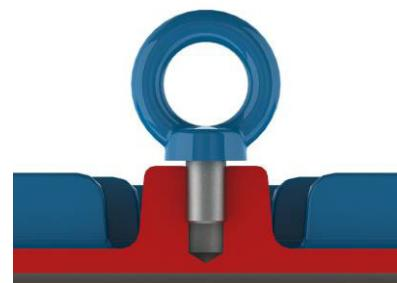
Figura 6 - Maneira incorreta de fixação do olhal de içamento
