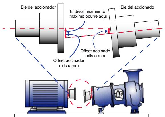
Figura 39 - Condición típica de desalineamiento.
