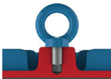
Figur 4.1 - Korrekt åtdragning av lyftögla
