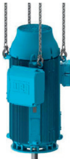
Figur 4.15 - HGF- och W50-motorerna till vertikal position
