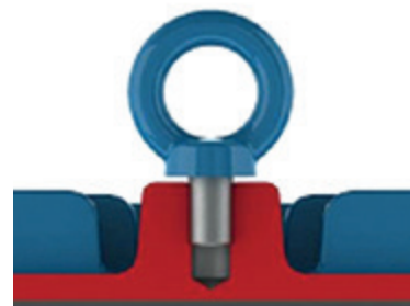
Figur 4.2 - Felaktig åtdragning av lyftögla
