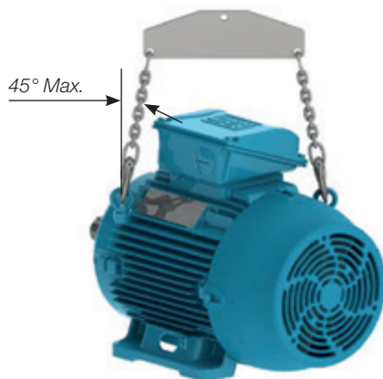
Figur 4.4 - Maximal följdvinkel för motorer med två eller fler lyftöglor
