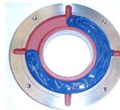
Figura 7.3: Anel de fixação externo do mancal
