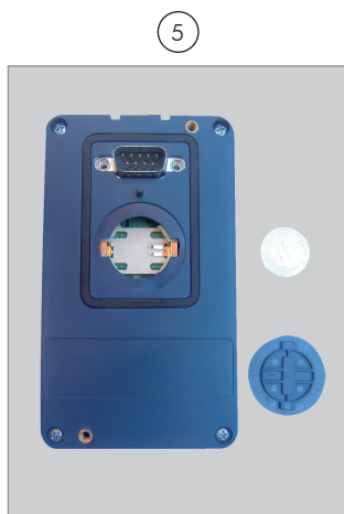
HMI sin la batería
