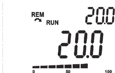
Abbildung 16.3: Beispiel für die MMS im Überwachungsmodus für den Gebrauch des PID-Reglers
