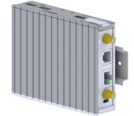
Figura 2.9: Gateway montado em trilho DIN
