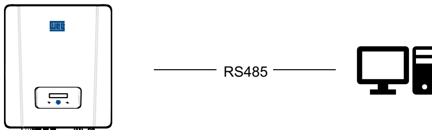
Figura 5.24: Comunicação Através de Rede RS485.
