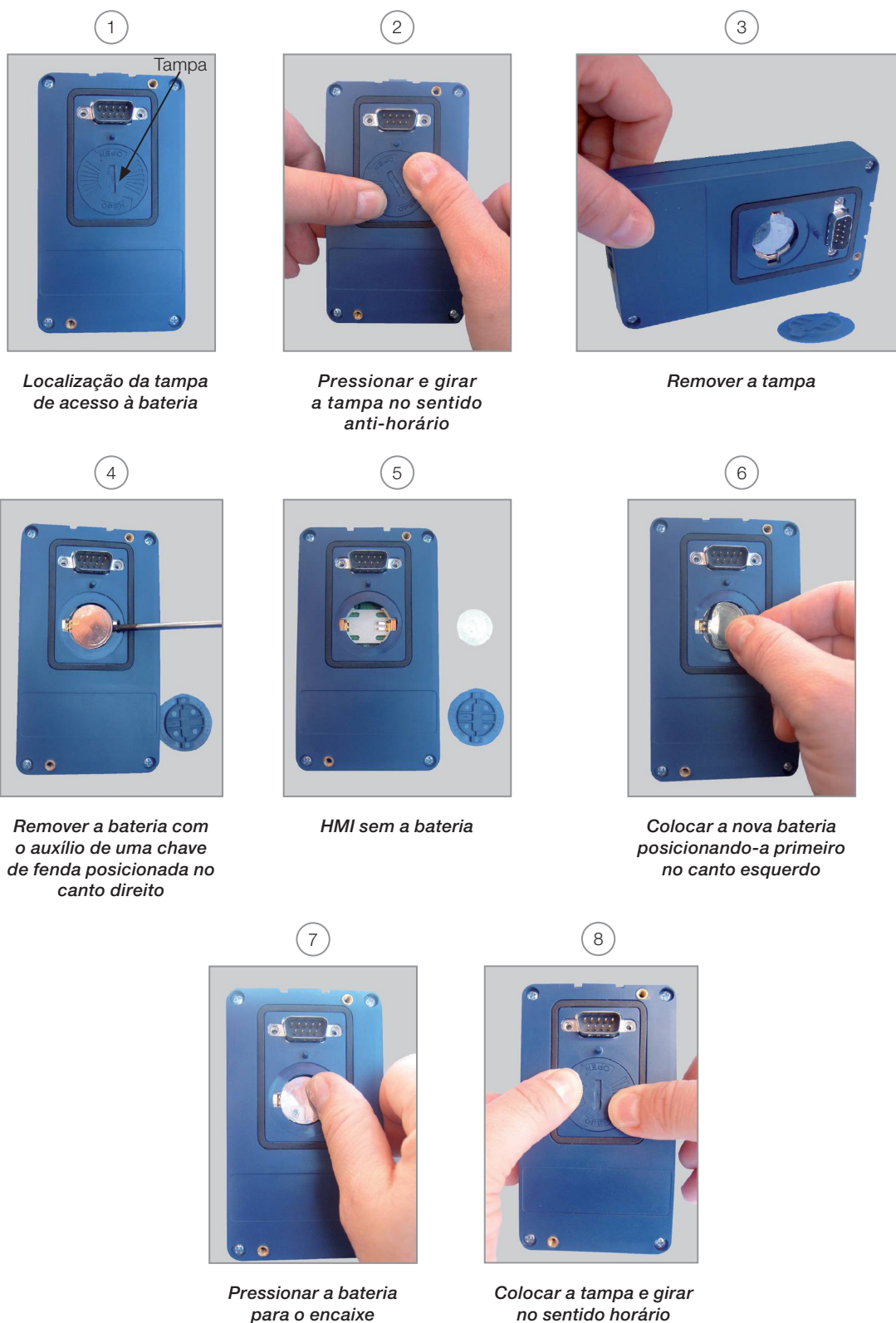
Figura 4.4: Substituição da bateria da HMI
